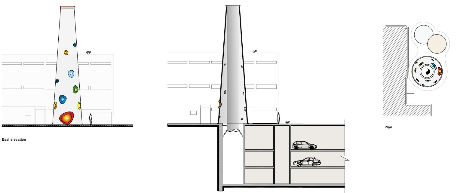
La chimenea se compone de una doble capa: un conducto interno cilíndrico y un armazón conífero de hormigón. Sobre la superficie exterior se realiza el montaje de piezas cerámicas irregulares, que van componiendo un revestimiento que decora este dispositivo de ventilación. Sobre un fondo blanco se distribuyen unidades cóncavas de distintos tamaños, de líneas ovaladas y márgenes suaves, cuyas vivas tonalidades resaltan en gran medida el aspecto estético de esta atractiva y colorida chimenea.
